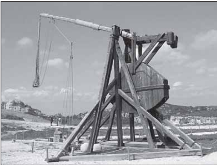
Imagen 1. Reproducción de un trabuco o trabuquete que lanzaba piedras redondas o bolaños a gran distancia y con buena precisión. Máquinas o "ingenios" de este tipo fueron utilizadas para la conquista de Tarifa. Fueron construidas en el norte de la Península y traídas a Tarifa por mar. A este tipo de ingenios donde el contrapeso (encerrado en un cajón a la derecha de la fotografía) se mueve a través de un eje lo llamaron los romanos bifas. (EGIDIO ROMANO: Glosa Castellana al "Regimiento de Príncipes" , edición, estudio preliminar y notas de Juan Beneyto Pérez, Centro de Estudios Políticos y Constitucionales, Madrid, 2005, pp. 1042-1044).
