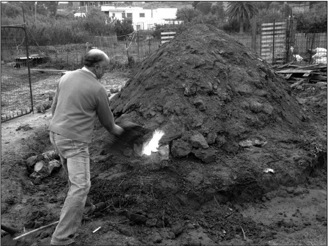
Figura 5. Momento del encendido de un horno de carbón. Foto autor
